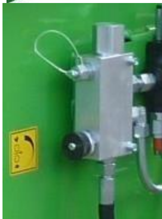
Padeves ātruma regulators Regulē slidošo ruļļu ātrumu diapazonā no 12 līdz 35 m/min
