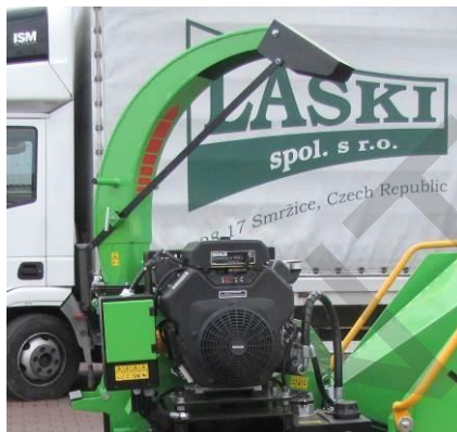
Izlādes kanāla uzstādīšana - stienis ar fiksatoru uzgaļa regulēšanai - rokturi izlādes kanāla pagriešanai
